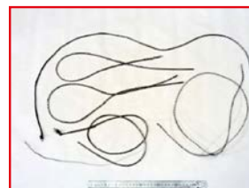
Rompevirutas MS (nuevo diseño)
